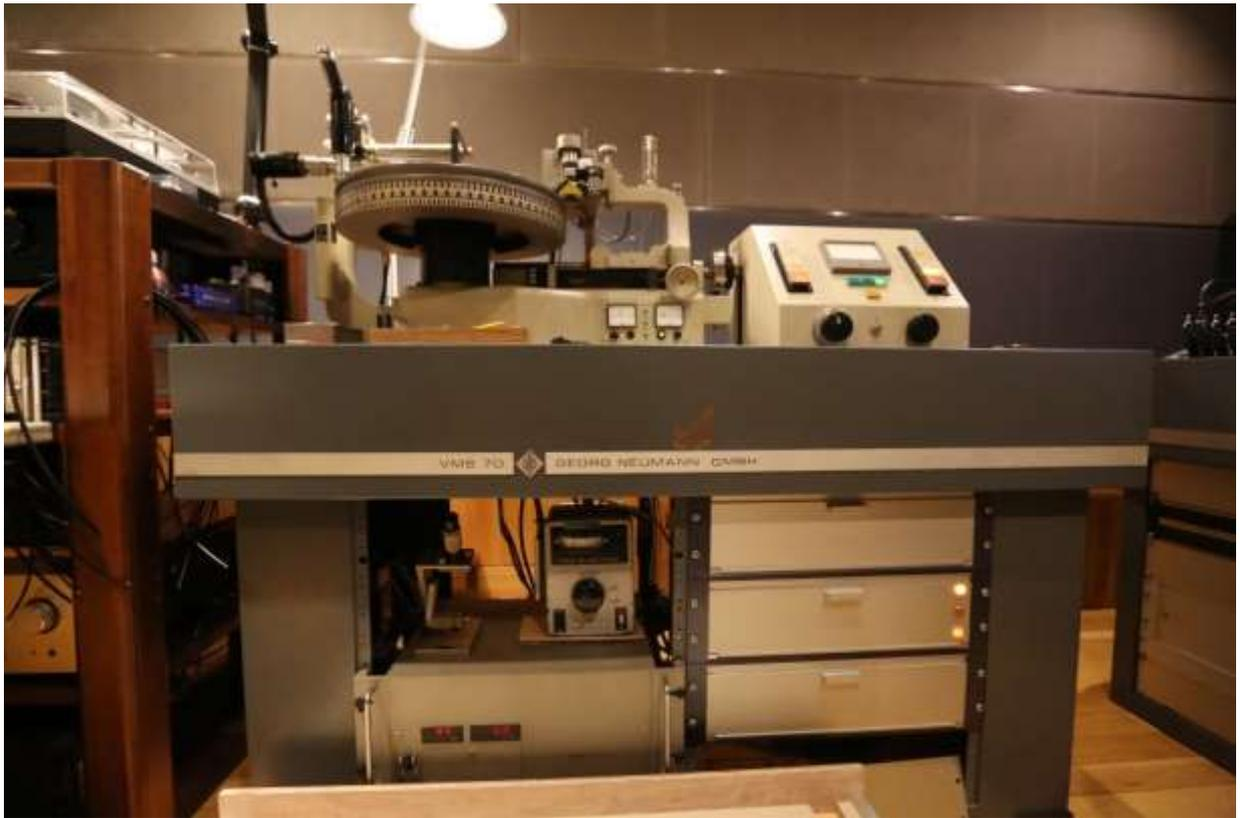
丁寧に梱包されていたという VMS 70 の本体はそれでも 22 年間倉庫に放置されていたから、ホコリまみれの状態だったようです。慎重に包みをほどくと特にカッティングレースとして重要な機構の一つ、カッターヘッドパート送り用ボールねじ（リニアアクチュエーター）は、潤沢に油が染みており大変良い状態で現れました。引き続き倉庫内を捜索して、エレクトロニクスサーキット（SAL 74）、カッターヘッド（SX 74）、カッティング針、専用の接続ケーブル類一式、コンソール部、運用マニュアルなどが次々と発見され、システムとして不足部分が無いことが確認できたのです。
