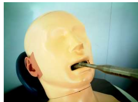
図-22 歯の切削時放射音(含超音波)のシミュレーション実験
