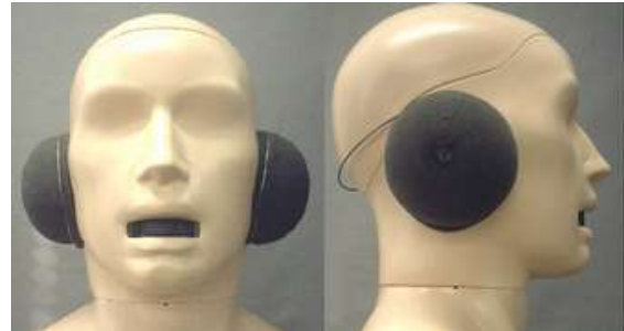
図-25 イヤーマフによる風雑音低減効果 とハイレゾ音波透過性の音響特性測定
