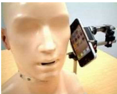
図-21 スマートホンの音響特性測定の様子
