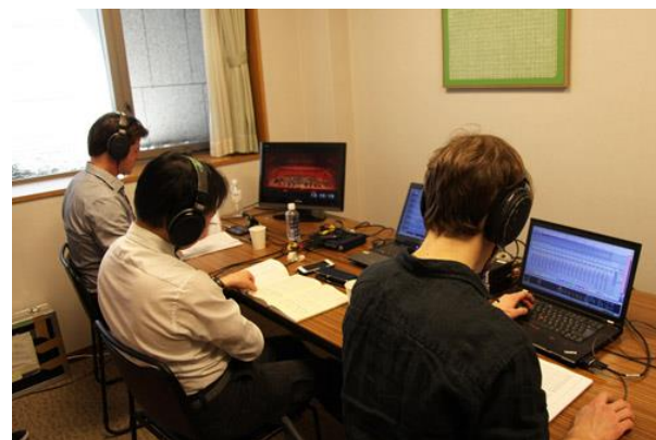
オール デトモルトーンマイスターチームによるレコーディング。 DAW Magix Sequoia と MADI Audio I/O RME MADIface XT を用いた 96kHz 24bit レコーディングシステムを用いている。
