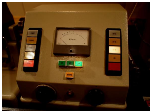
(写真左) カッティングヘッド SX74 (写真右) カッティングピッチ監視用のメーター
