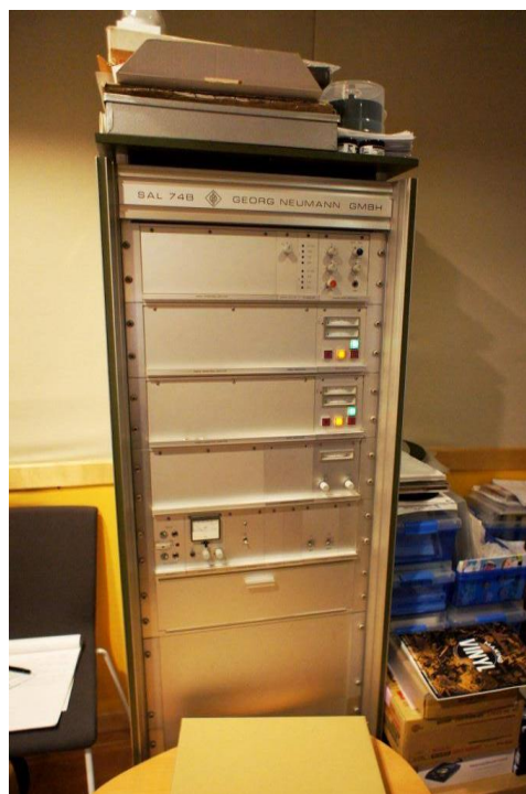
(写真中左) カuttingヘッド SX74 (写真中右) ノイマン製コンソール本体 (写真下左) Electronic Package SAL74
