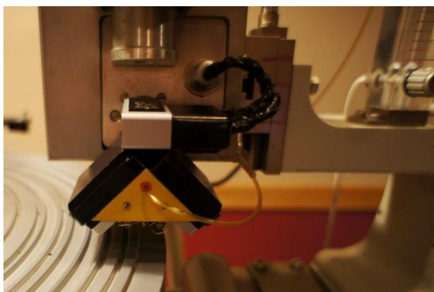
(写真左) カッティングヘッド SX74 (写真右) カッティングピッチ監視用のメーター
