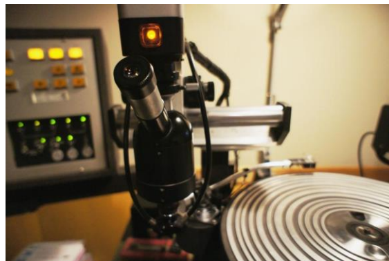
(写真左) 操作盤を見る (写真右) 盤面検査用の顕微鏡
