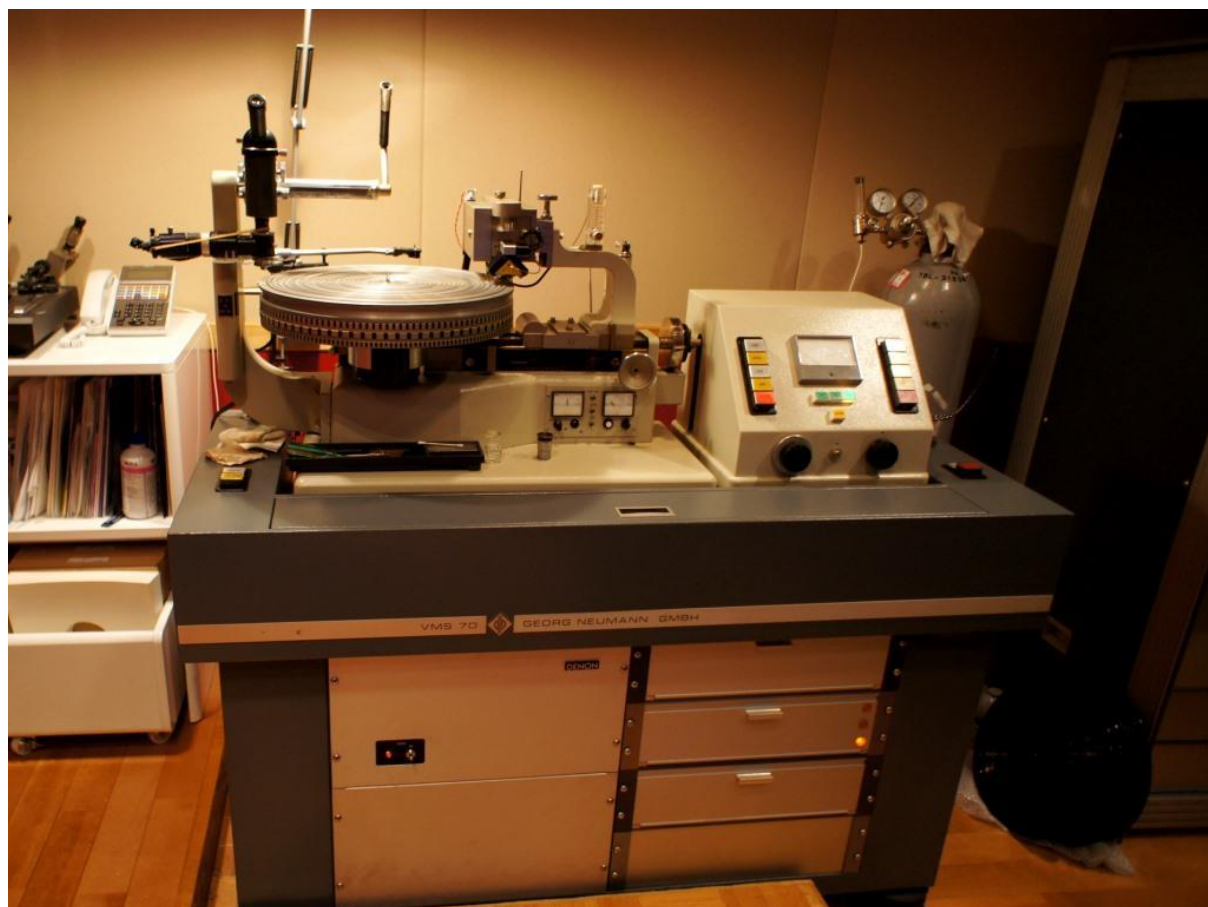
(写真上) カッティングレース VMS70 ターンテーブル駆動は DENON 製モーター
