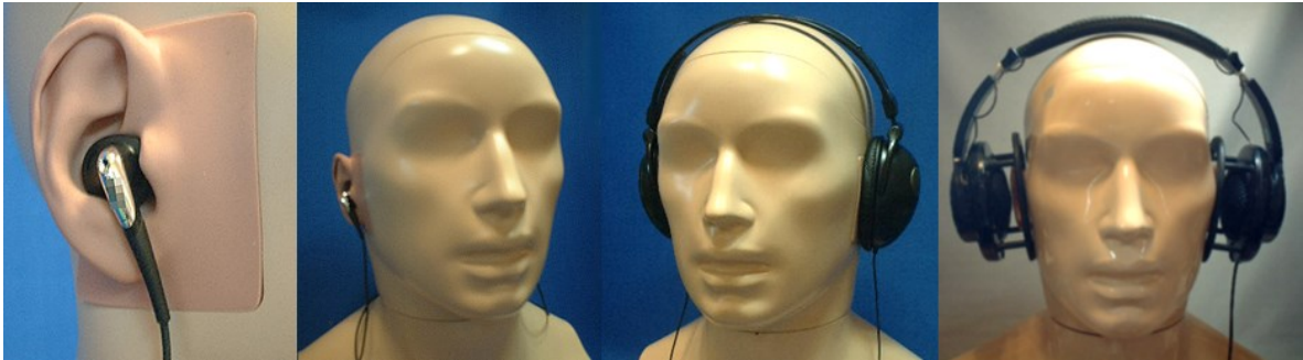
図9 ヘッドホン/イヤホン測定の様子 (サザン音響 SAMAR HATS Type4500)
