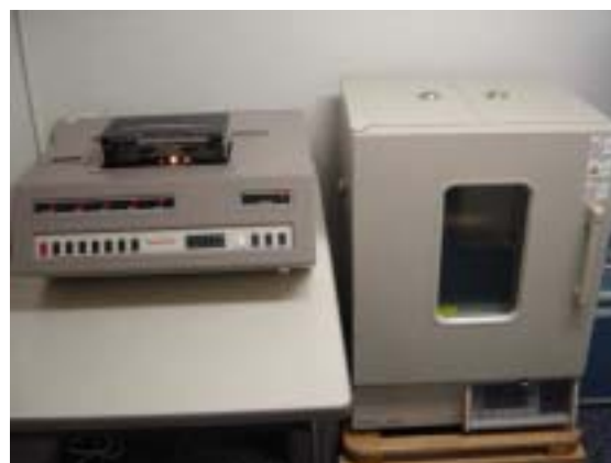
(写真2) 左がU マチックテープクリーナー 右はアナログテープ用乾燥機
