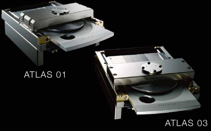
VRDS(Vibration-Free Rigid Disc-Clamping System)は、ESOTERIC がこだわり続けてきたCD/スーパーオーディオCD トランスポートメカニズムの基幹技術です。ディスクをターンテーブルにクランプして回転させ、ディスク自身の回転振動やメカニズムの不要振動を徹底して排除します。また、ターンテーブルでディスクの反りを矯正することで、光学ピックアップとディスクピット面の相対光軸精度を大幅に向上させたことにより、サーボ電流を極小化。これらにより、ディスク読み取りエラーの大幅な減少と優れた音質を実現します。
