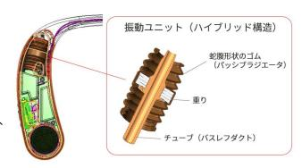
伝わり、より臨場感を高めることが出来ます。通常のパッシブラジェータですと、スピーカーと同等以上の面積が必要となり、デザインや重量への影響が大きくなりますが、新開発の"振動ユニット"によって、低音域から高音域までバランスのとれた高音質、振動による臨場感、及び、デザイン性と軽量設計を実現することが出来ました。
