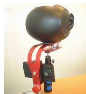
図-12 スタビライザーに取り付けた SAMREC Type1500の例
