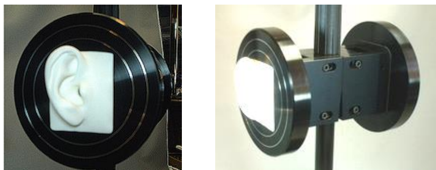
図-10 “耳殻付マイク”としても使用できる 大型測定テーブル(Type4588S)
