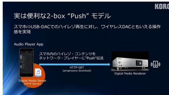
である。3-box は、スマホなどのアプリとしてコントローラーが独立し、サーバーからレンダーにデータを送らせて再生する方式である。これらのサーバーは実は HTTP サーバーであり、インターネット上からのファイルのダウンロードと同じことをやっている、シンプルなモデルである。
