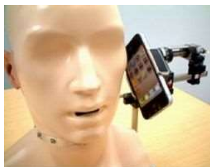
図-21 スマートホンの音響特性測定の様子
