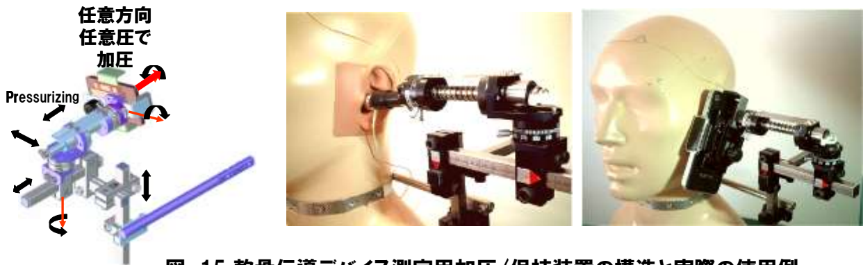
図-15 軟骨伝導デバイス測定用加圧/保持装置の構造と実際の使用例
