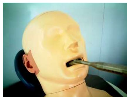
図-22 歯の切削時放射音(含超音波)のシミュレーション実験
