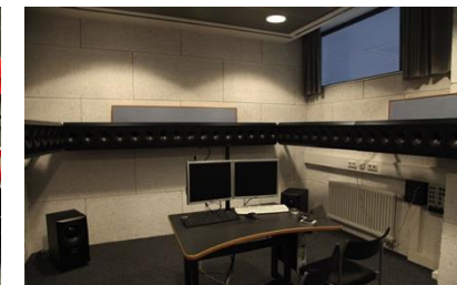
Wave Field Synthesis 84 個のスピーカーによる波面合成の研究施設
