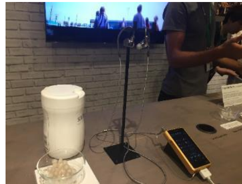
DMP-Z1: 欧州発表は初となるフラグシップイヤホン。マグネシウム製インナーハウジングに 2 ダイナミックドライバー、1BA を組み込んでいる。欧州での販売価格は 2,200 ユーロ前後を予定
