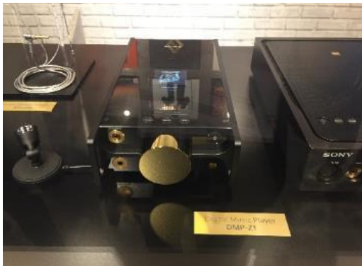
IER-Z1R: 据え置きアンプに匹敵するサイズのアンプブロックに、同社ワークマンに準じる液晶ディスプレイと UI を組み込んでいる
