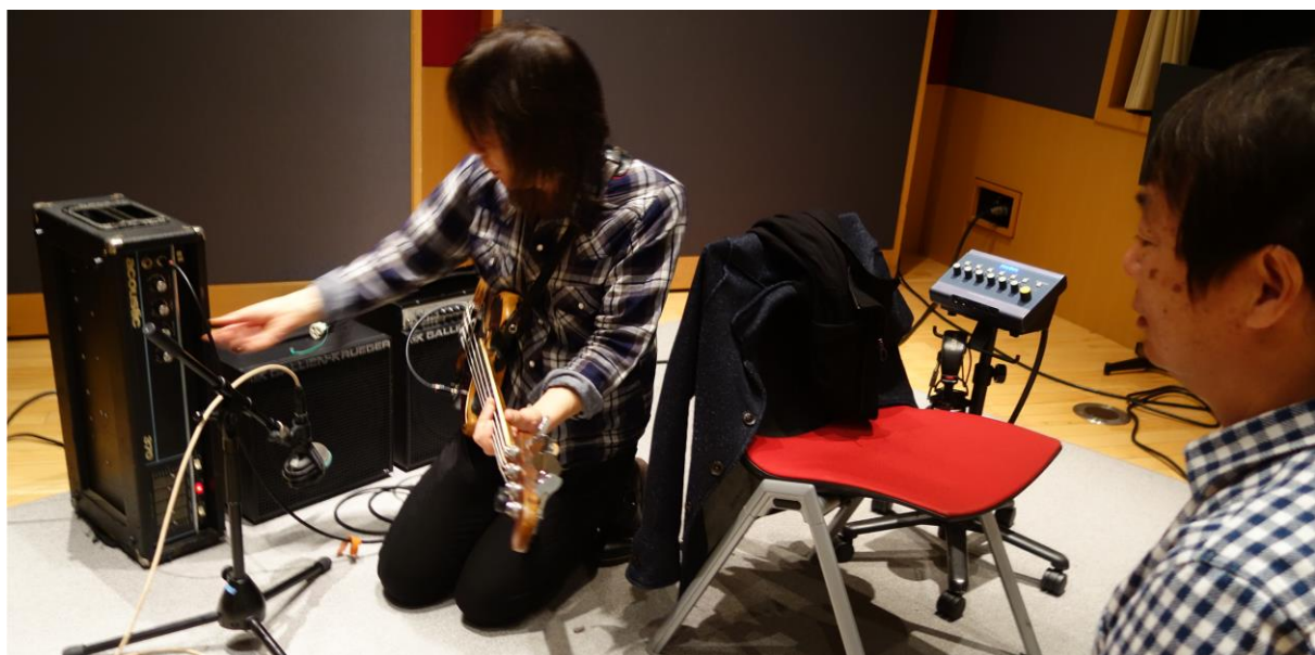
持ち込まれたベースアンプヘッドとスピーカー部を調整してマイクロホン位置を決めます
