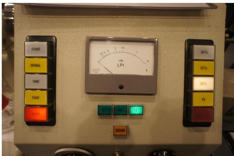
マシンのコントロールボード中央のメーター（LPI）はカッティング溝間隔を設定するもので、インチ表示仕様。メーター下にはカッティングする盤の大きさ指定スイッチが見え、右側列には回転速度 16 2/3、22 1/2、33 1/3、45 から選択可能で、ハーフスピード製作にも対応していることが判ります。
