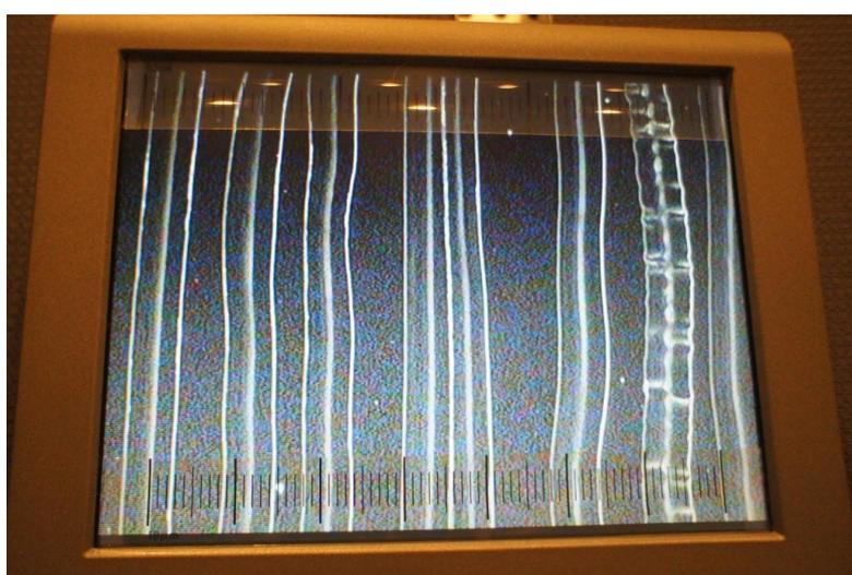
カッティングされたラッカー盤の状態を検視する。顕微鏡から直接視ることも可能で、このように取り付けられたカメラ映像からモニターでも確認できます。写真中央には二本の溝が密着したように走る様子が判る NG の例。音楽信号が大きくなる場合カッティングヘッドの送り速度を速くしてこういった溝接近のケースを未然に防ぎます。
