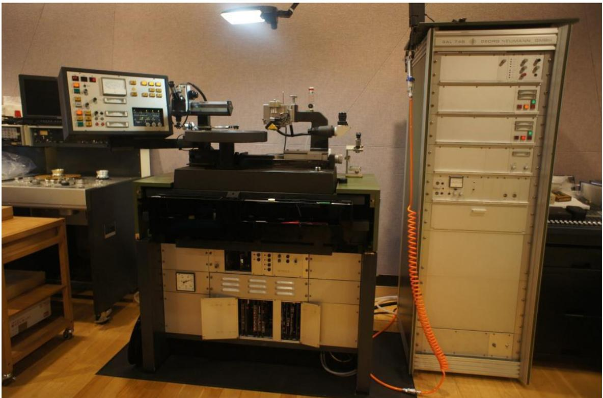
写真は Cutting Lathe VMS80、Head SX74、Electronic Package SAL74 で、VMS70 と比較してマシン本体がコンパクトなことで操作ボードの違いが目につきます。床の黒い部分はフローリング材が切りとられており建物構造体に直結設置されています。VMS80 は本体と旋盤間に振動防止構造があり直接は固定されておらず、従ってマシンの設置場所にさほど神経質になる必要がないようです。
