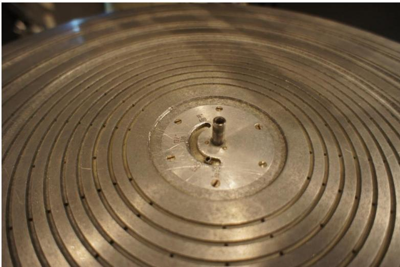
プラッター天面には回転方向にいくつも溝があり、さらにはその中には空気穴が点々と見えています。ラッカー盤を圧着させるためのバキューム機構で、軸の左手に半円C字状の中に小さなレバー（手前側にポツンと見える）があり、ラッカー盤の大きさに従ってバキューム範囲を選んで空気の経路を切り替えます。
