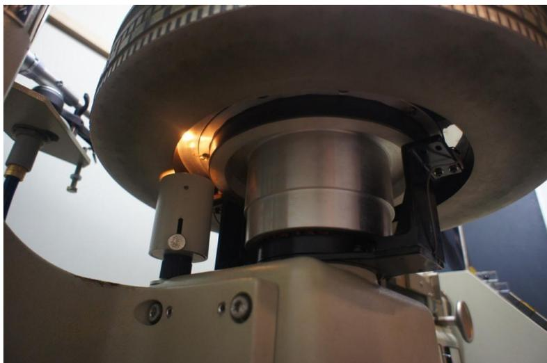
プラッター裏に光るランプは NEUMANN オリジナルの回転検出用。その内側に黒い帯がリング状に見えるところが回転検出用信号の磁気コーティング部で、180 度の対向で検出ヘッドが二つと、その中心部には 21 極コイル仕様ローターの収まるケースの輝きが見えます。
