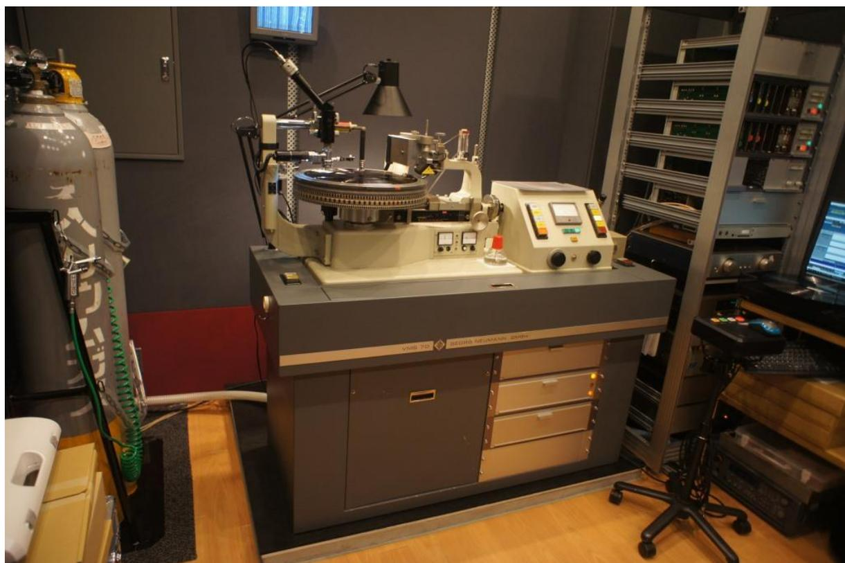
NEUMANN（ノイマン）製のカッティングマシンはすでに製造を取りやめて久しいので、新たに導入するには中古市場で探すしかありませんが、北米からの紹介でとても程度の良い個体に巡りあったとのこと。全てを分解した状態で輸入し部品状態で徹底した洗浄を施した上で、ソニーミュージックグループの技術スタッフが自力で組み上げられたマシンは Cutting Lathe VMS70、Head SX74、Electronic Package SAL74 で、スタジオの一角に専用スペースが新たに作られ収まっていました。
