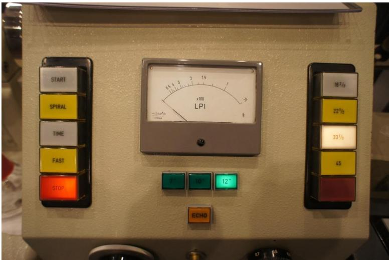
マシンのコントロールボード中央のメーター（LPI）はカッティング溝間隔を設定するもので、インチ表示仕様。メーター下にはカッティングする盤の大きさ指定スイッチが見え、右側列には回転スピード 16 2/3、22 1/2、33 1/3、45 から選択可能です、ハーフスピード製作にも対応していることが判ります。
