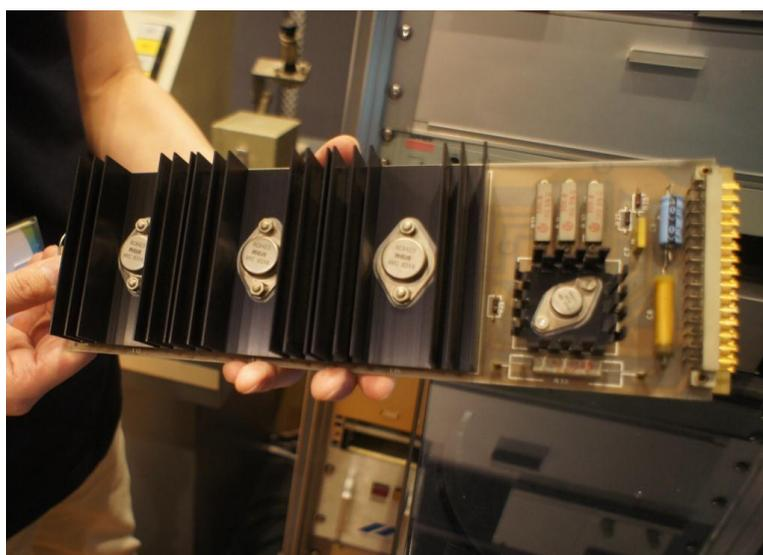
上左の写真は信号系のラック Electronic Package SAL74 のケース中を見たところ。青、黄、緑、赤のシールが見える八つのボードがカッティングヘッドをドライブするパワーアンプ部。上右の写真はそのうちの一枚でキャンタイプのパワートランジスタ（3 平行）が使われており、二組の増幅回路をブリッジ接続する仕様でチャンネルあたり 600W もの大パワーを供給しています。
