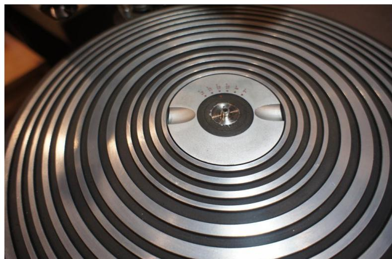
また、ラッカー盤を圧着するためのバキューム機構も空気の通り道がプラッター軸内に収まっているため、更に外観がスマートに見えています。プラッター天面の模様やラッカー盤のサイズ指定の切り替え機構も違うことが見てとれます。
