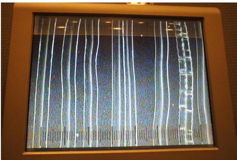
カッティングされたラッカー盤の状態を検視する。顕微鏡から直接視ることも可能で、このように取り付けられたカメラ映像からモニターでも確認できます。写真中央には二本の溝が密着したように走る様子が判る NG の例。音楽信号が大きくなる場合カッティングヘッドの送りスピードを速くしてこういった溝接近のケースを未然に防ぎます。
