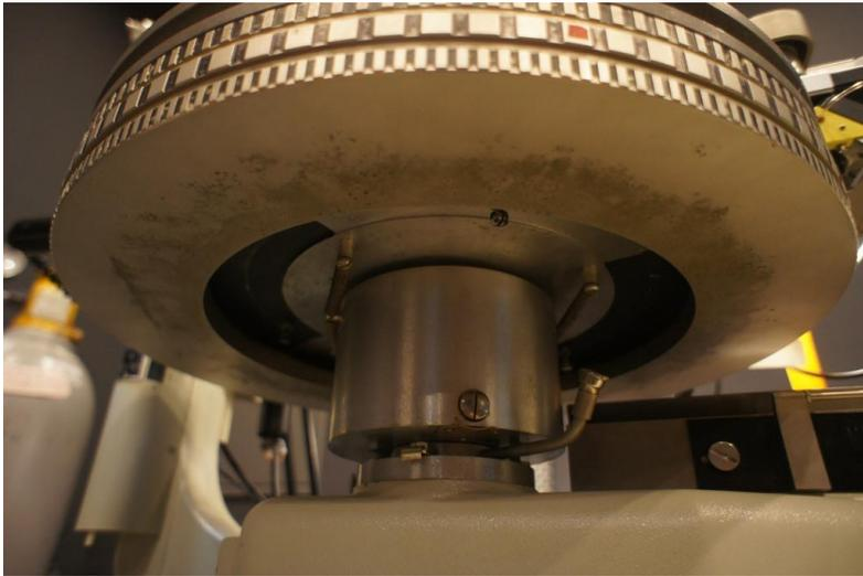
巨大なプラッターの裏側を覗くと回転系のベアリングへの注油口が金管楽器のマウスピースのように見えますが、回転検出用のランプも軸の後方（写真の向こう側）に取り付けられています。モーターの持つトルクではこの重量級のプラッターを始動させるにはあまりに非力で、オペレーターが作業の度に手回しで始動する必要があります。
