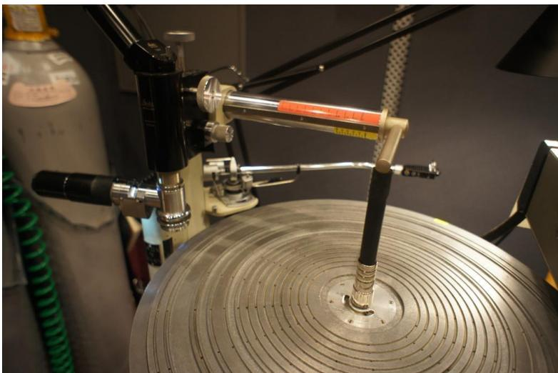
プラッター軸に上から差し込まれたバキューム用のパイプ。ラッカー盤を装填したのち降ろされる。プラッターの奥には検聴用のトーンアーム SME 3012が見え、ピックアップカートリッジは定番の DENON DL-103 が付いています。
