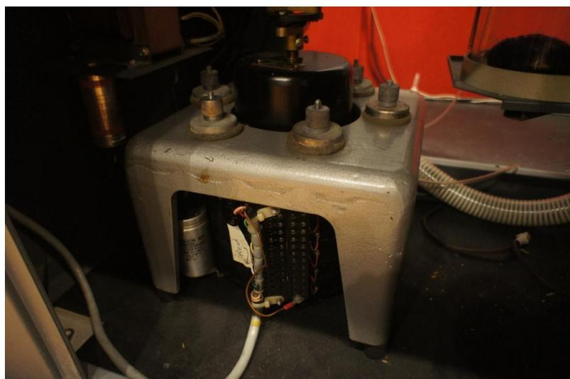
ここに据え付けられたカッティングマシンの特徴は駆動方法にあるのではないのでしょうか。筐体底面近くに収められたモーターはNEUMANNが出荷したままのオリジナルで、およそ1mのシャフトで天面に備わるプラッターに直付けされています。これまで国内で稼働していたVMS70マシンのほとんどは駆動機構がダイレクトドライブ方式モーターに交換されていました。
