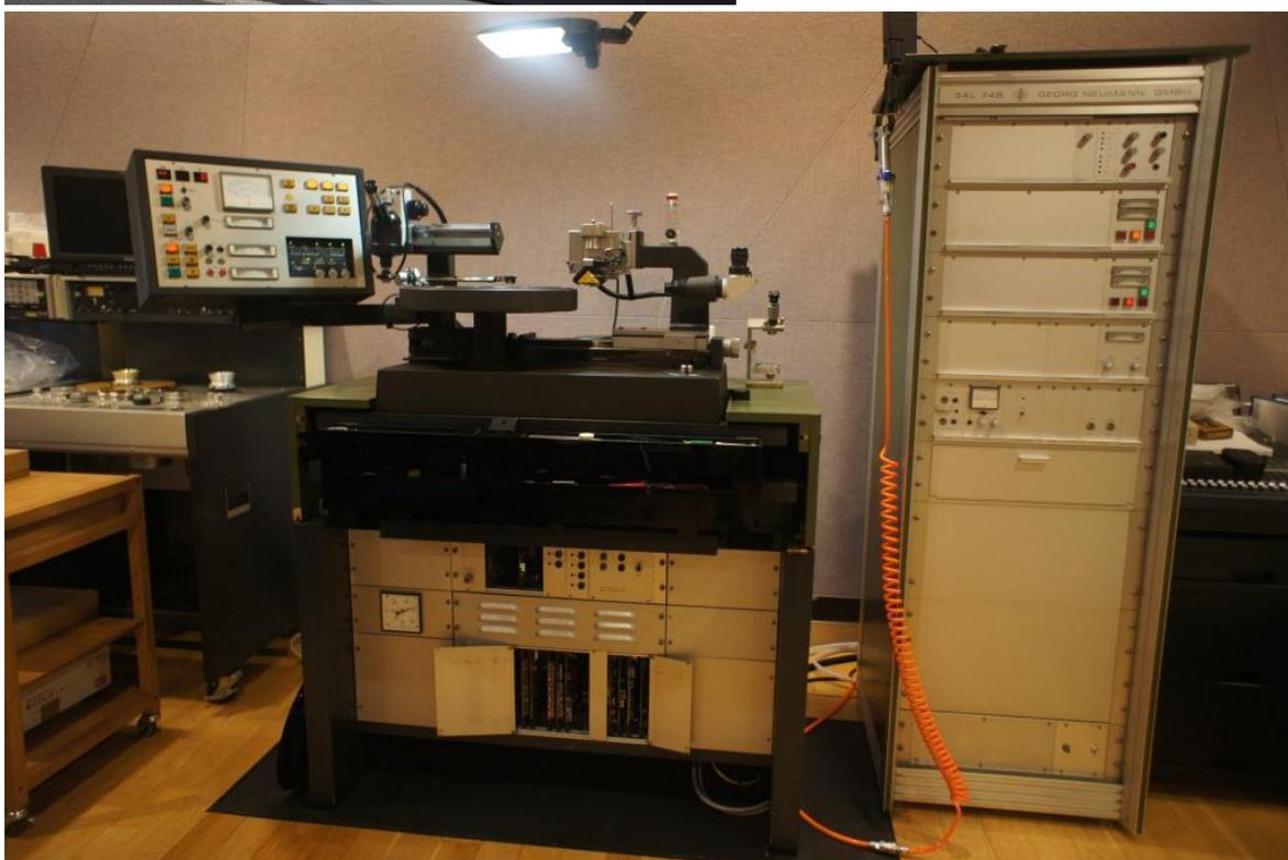
写真は Cutting Lathe VMS80、Head SX74、Electronic Package SAL74 で、VMS70 と比較してマシン本体がコンパクトなことと操作ボードの違いが目につきます。床の黒い部分はフローリング材が切りとられており建物構造体に直結設置されています。VMS80 は本体と旋盤間に振動防止構造があり直接は固定されておらず、従ってマシンの設置場所にさほど神経質になる必要がないようです。
