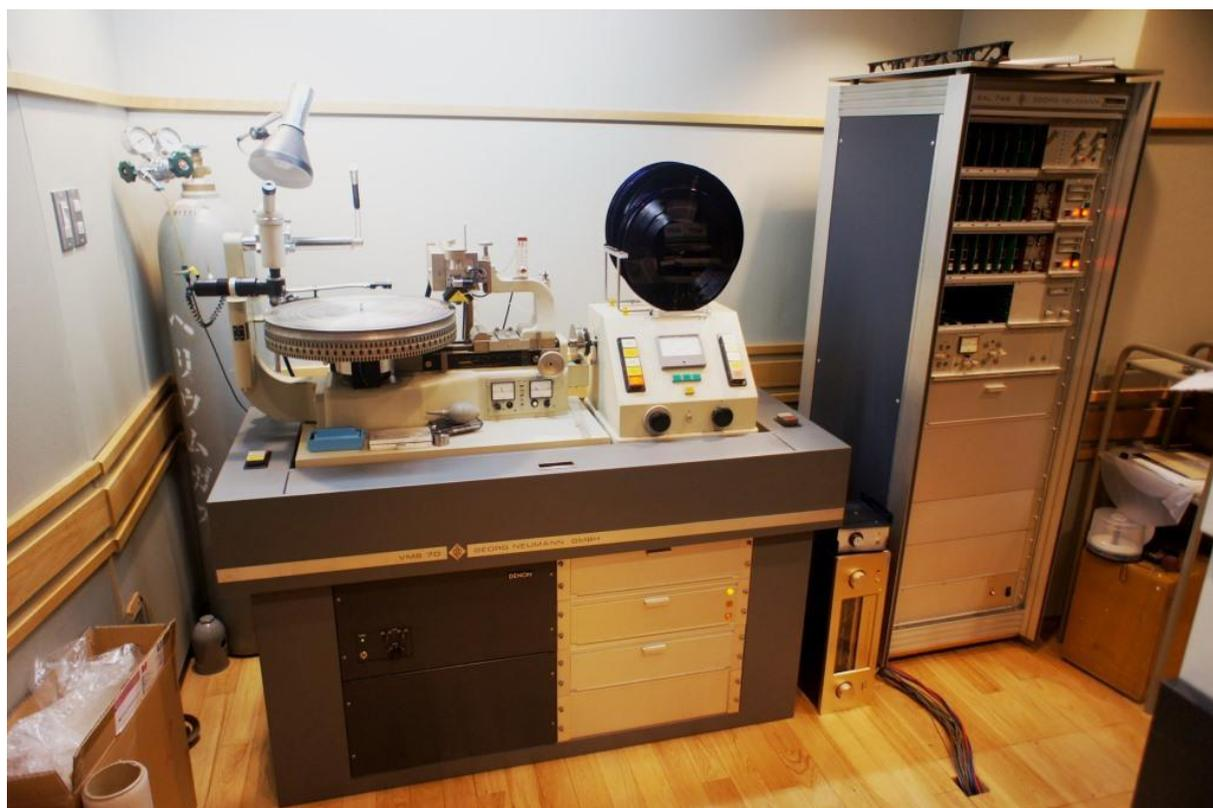
写真は Cutting Lathe VMS70、Head SX74、Electronic Package SAL74 で、一番の特徴は VMS70 の駆動モーターが DENON 製に交換装着されている点でしょう。
