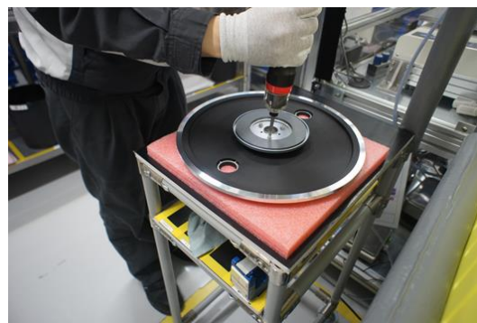
シート固定の重しプレートを載せ 30 分放置（写真左）フェライト磁石取付（写真右）
