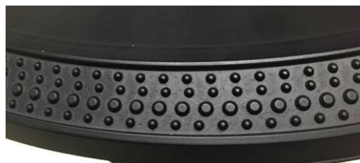
塗装後切削処理直前のターンテーブル（ストロボ用の縞目が突起している）
