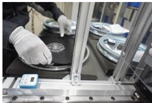
納品されたターンテーブル裏面に接着剤塗布（写真左）ラバーシートを貼付け（写真右）
