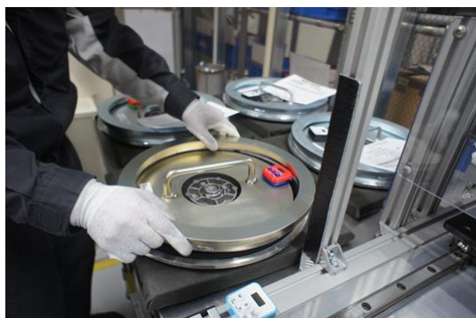
シート固定の重しプレートを載せ 30 分放置（写真左）フェライト磁石取付（写真右）
