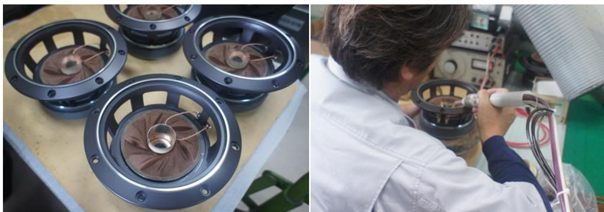
① ボイスコイルボビン等装着されたフレーム（写真左） ②ボビンに接着剤を塗布（写真右）
