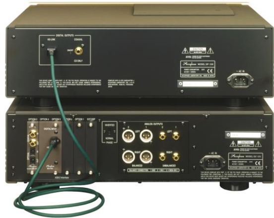
HS-LINK 接続の例 (写真右)
