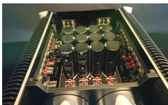
350,000 \mu F 以上の電解コンデンサが並ぶ
