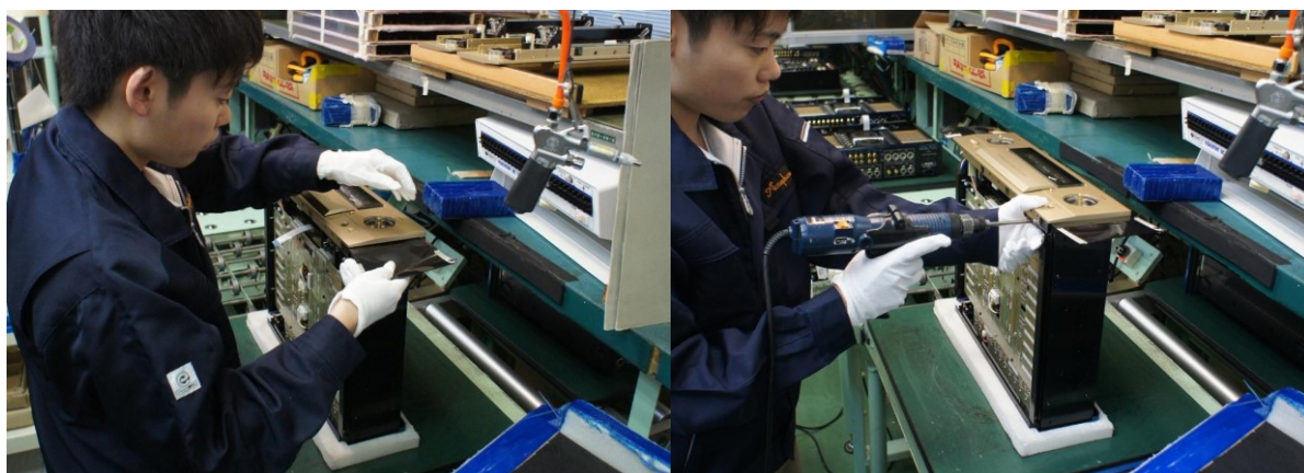
パネル取付 専用治具（スペーサー）を挟み正確に位置合せを行う
