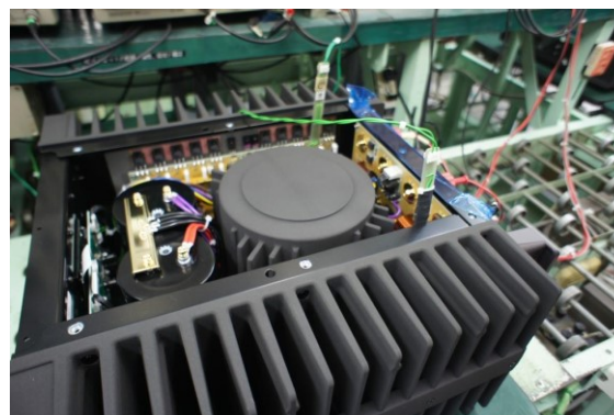
ライン上で最初に電源を入れる時のスライダック（写真左）電気調整中の A-70（写真右）
