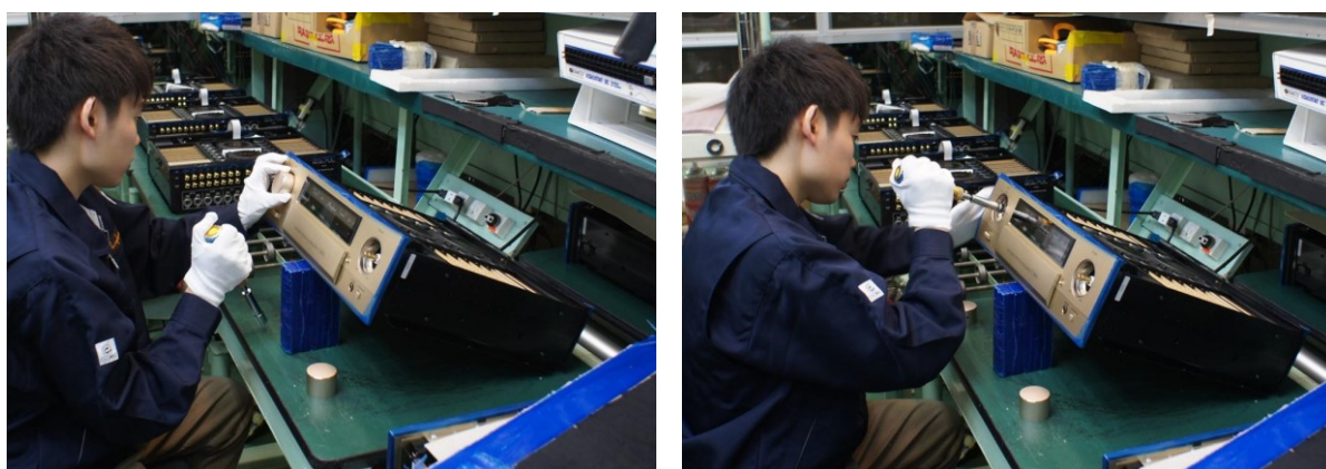
ボリュームノブ取付作業 センター出しのためにもう一度ナットを緩めて位置を調整
