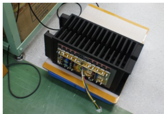
ライン上の A-70 本体シャーシ（写真左）と取付を待つヒートシンク部分（写真右）
