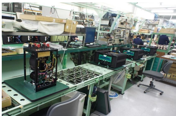
ライン上の A-70 本体シャーシ（写真左）と取付を待つヒートシンク部分（写真右）
