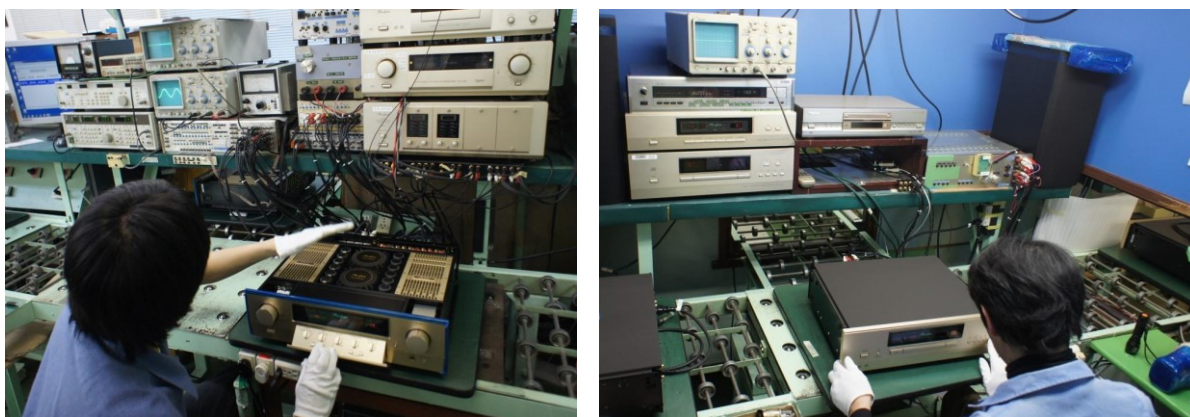
再び電気調整工程に入る C-3850（写真左）と最終音出し確認中の DP-560（写真右）
