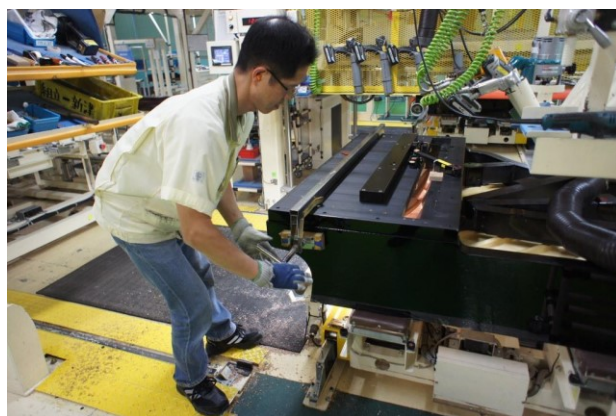
棚板の取付 本体をうつ伏せにして治具を用いて正確な位置合わせを行う
