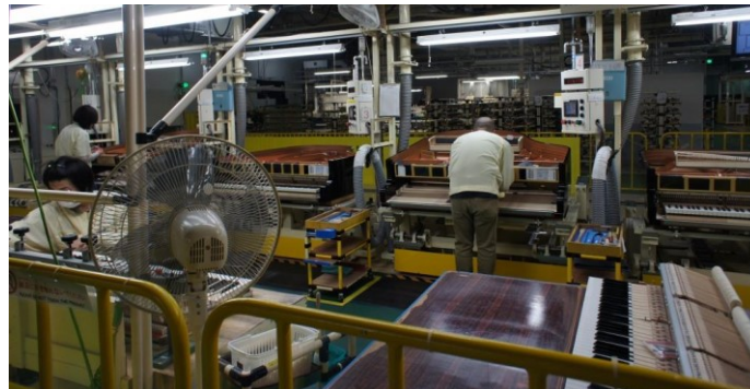
ピアノアクション機構の取付工程
