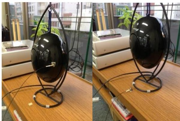
図 8 スピーカキャビネットと置台の振動加速度測定～フレームスタンド
