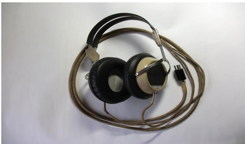
写真 1. スタックス静電型イヤースピーカーSR-1の外観（イヤープッドのみ最近交換）
