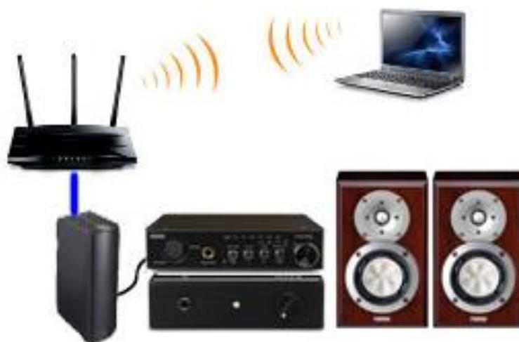
USB DAC である「HP-A4BL」は PC と USB で接続し使用するのが、いちばん手軽で一般的ではありますが、音楽を聴くのに毎回 PC と DAC を USB ケーブルで接続する習慣が無くなってしまった筆者は上記の様に、株式会社バッファロー社のデバイスサーバー機能に対応した「NAS: LinkStation LS400 シリーズ」に「HP-A4BL」を接続し、離れた PC から Wi-Fi 経由で NAS をコントロールし音楽を楽しむ環境を構築しました。詳しくはハイレゾ再生に積極的に取り組んでいる株式会社バッファロー社ホームページ「USB オーディオを楽しもう USB-DAC を離れた PC から再生する」 (<http://buffalo.jp/products/digitalkaden/audio/usb-dac/>) を参照ください。
