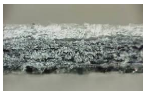
2層抄紙 MRC 振動板断面
