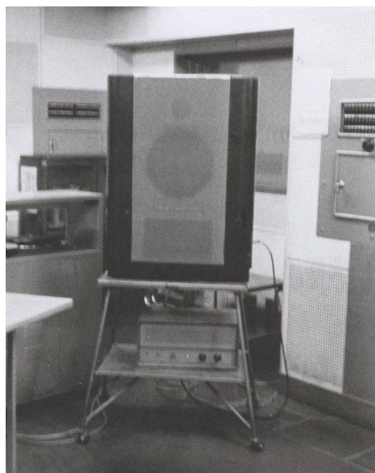
写真 4. NHK 放送会館(内幸町)の調整室に設置された 2S-305 型放送用モニタースピーカー
