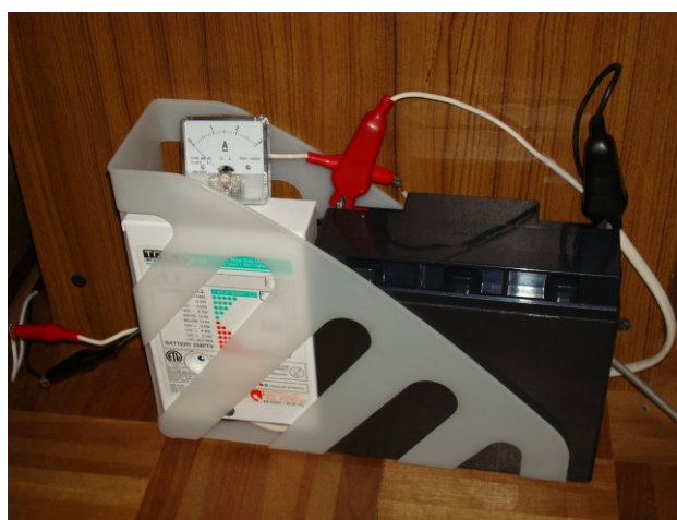
隣室に置かれた電源装置。太陽光発電素子から送られる電流を蓄電池に蓄え、DC/DC変換でアンプに送る
