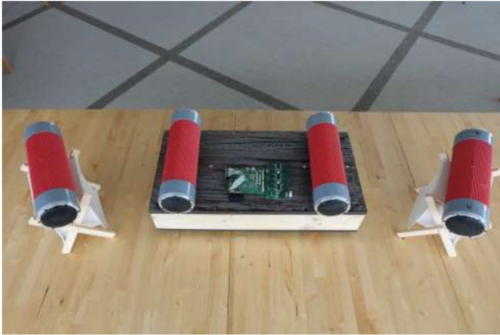
写真Ⅲ- 5 新しい構想による自作音場再生システム (無反動スピーカー4本、サブウーファー、信号処理ボード、アンプ基板)
