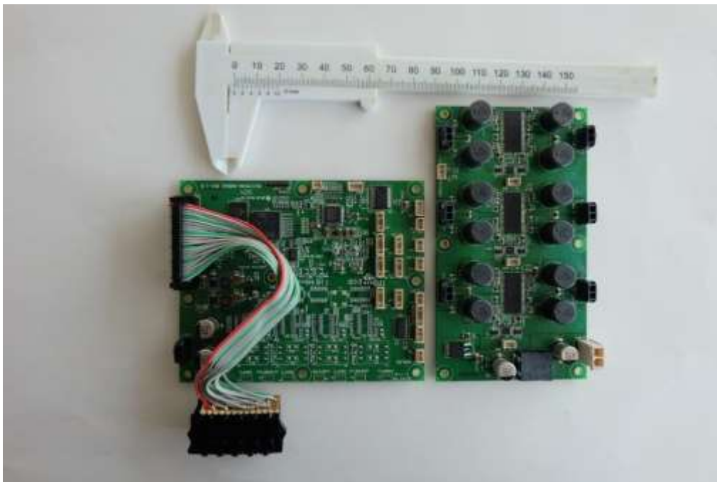
写真Ⅲ-4 新しい構想による音場再生システムの信号処理基板とアンプ基板
