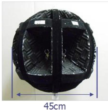
図2 音響遮蔽板を用いた球形マイクロホン
