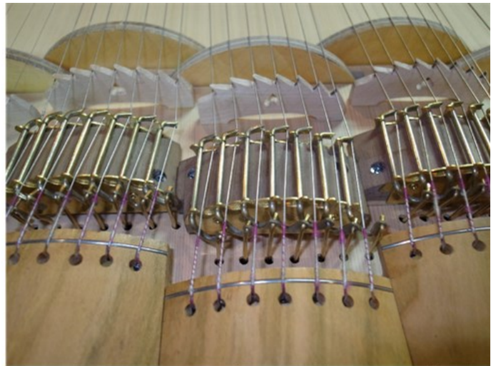
図 4.16 弦はレバーで引き下げられて、回転している摩擦円盤に接触して音をだします。
