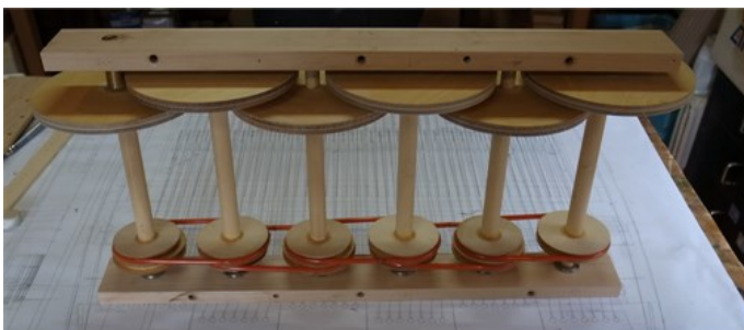
図 4.15 摩擦円盤の回転速度は低音側は遅く、高音側は速くなるようにプーリーのサイズで調整。
