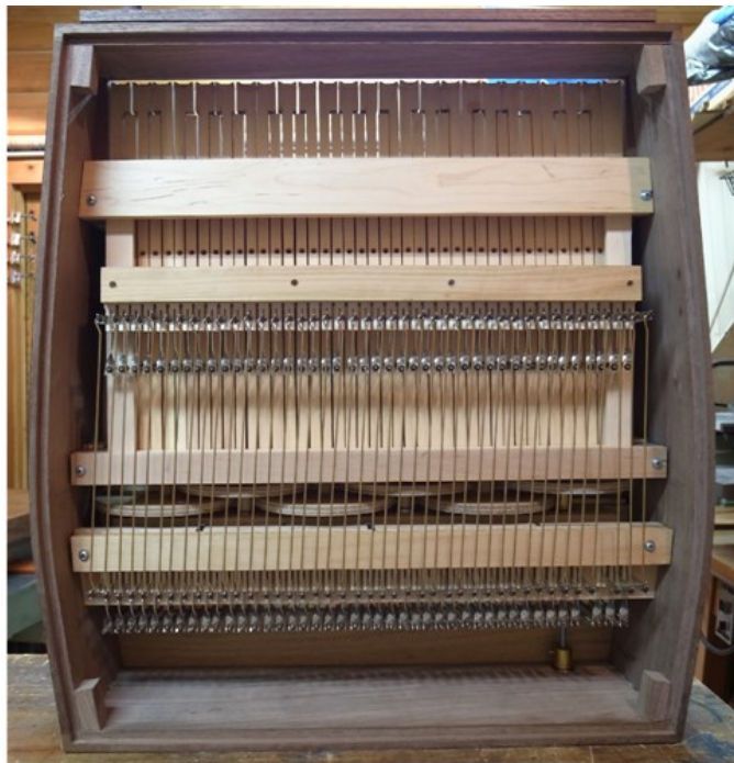
図 4.17 手前にある鍵盤の動きを楽器の後ろにあるレバーに伝えるためのトラッカー。
