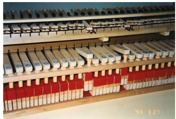
図 4.8 鍵盤のテコを反転する機構
