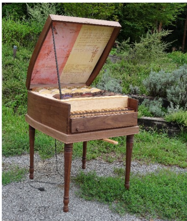
図 4.18 モータードライブのため、電源コードが垂れ下がっています。手前に突き出ているのは膝で操作するレバーで摩擦円盤の回転数をコントロールします。
