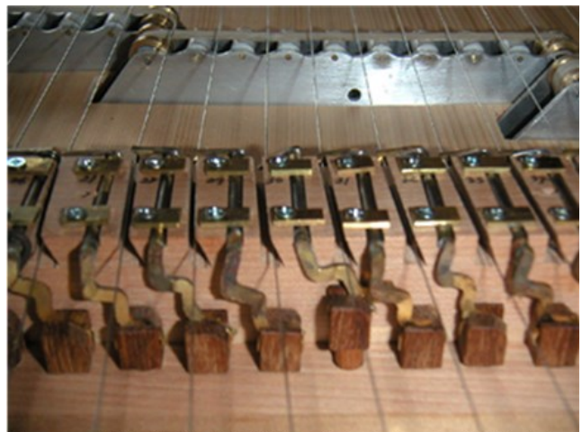
図4.11 鍵盤を押すと弦が奥に見えるベルトに接触する。
