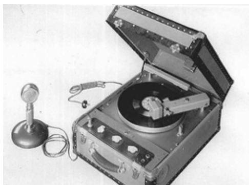
写真 36-8 DENON RC-1 型円盤録音機
