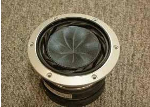
製法は、木材パルプ バナナパルプ カーボンファイバー 芳香族ファイバー セルガイアファイバー バイオセルロース パールマイカ の7種類の材料を最適比率と最適な順序でブレンドして調液したものを、フォステクス独自のラジアル抄紙(PAT)と乾燥ノウハウを駆使して作成しており、すぐれた物理特性を実現しています。
