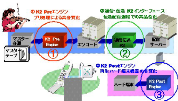
図3 . 音楽配信、圧縮音楽に向けた高音質化への取り組み
