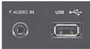
図7. USB入力端子とアナログ入力端子 (フロントパネルに2つの端子が搭載された例)
