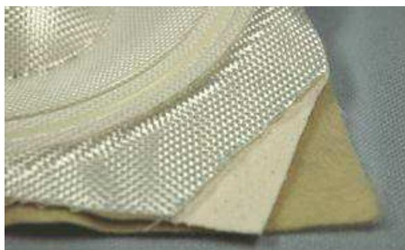
A-OMF MONOCOQUE 振動板の構成
