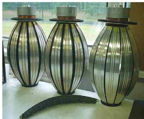
音の秘密を握るウーファのダイアフラムはアルミニウムとマグネシウムの合金製。熟練工によって一枚一枚が手作業プレスで作られ、裏に特殊なダンブ材が貼られて完成する。
