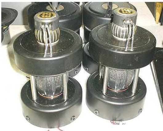
ツイーターとスクーカーのダイヤフラムは軽量高剛性のカーボン・ファイバーを用い、ウーファーとの音のつながりを重視してチューニングが施されている。
