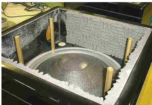
サブ・ウーファーは直径 30cm、ボイスコイルの直径も 10cm と大きく、またリニアな最大振幅も 14mm (P-P) と余裕を持っている。
