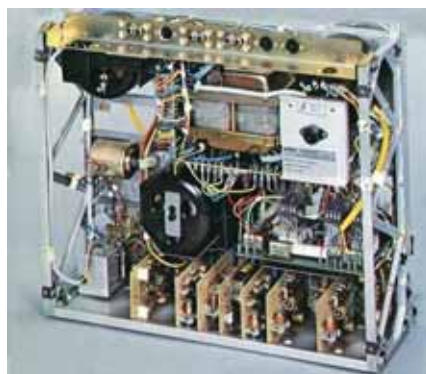
写真 55-9 Revox A77 型の内部 (410)
