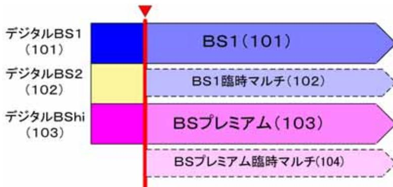
NHK では、雨に弱いといわれる BS 放送の弱点をカバーするために、通常放送をしている変調方式よりも雨に強い変調方式を用いた小容量の降雨減衰対応階層伝送と呼ばれる放送を付加してきました。今回の 2 波化再編成でも、これまでのハイビジョン放送と同様、必要に応じて随時実施する事にしてあります。この放送は通常の BS デジタル放送が TC8PSK 変調で伝送されているのに対して QPSK 変調で伝送を行うもので、この放送を実施するためには最低 2 スロット(2Mbps 程度)の伝送容量を通常の放送から供出しなければいけません。このため、通常放送の画質を維持するために、降雨減衰が予想される場合や緊急の場合にのみ行うこととしています。
