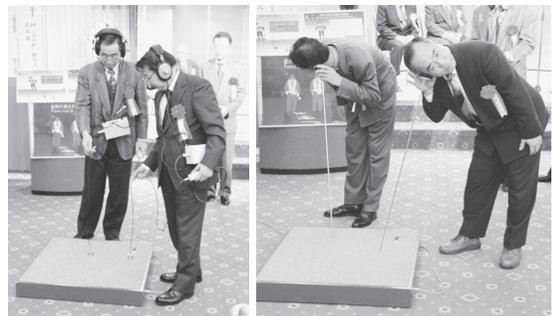
電子式漏水発見器(写真左)と音聴棒(写真右)を使った
