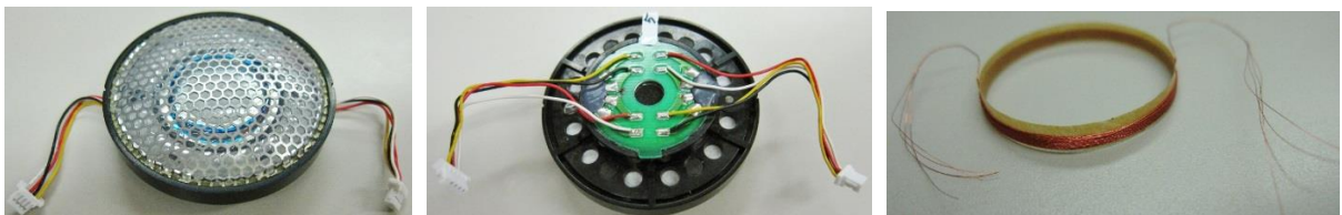
図.3 4 コイル・ドライバーユニット(左：表側、中央：裏側、右：ボビン巻ボイスコイル)
