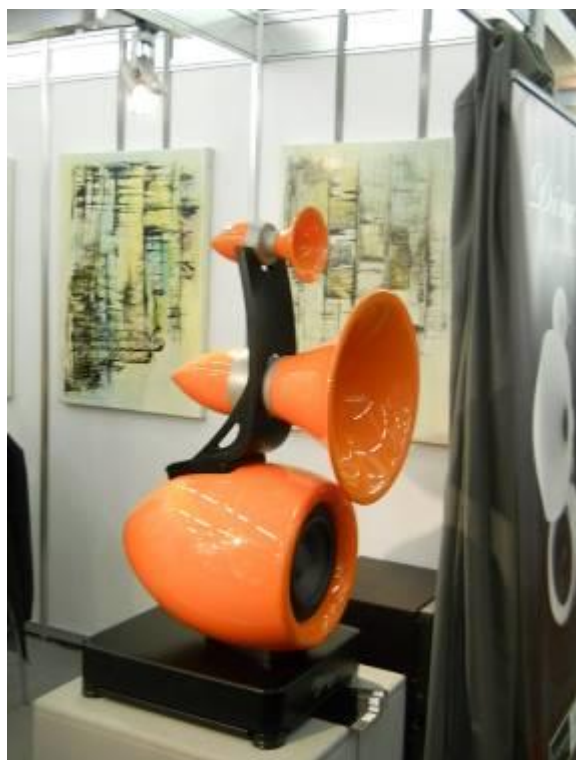
(写真 9) オーストリアの Vienna Physix の ホーンスピーカーDiva grandezza、ミッドと ハイがホーン、バスがアクティブのハイブリ ッド構成
