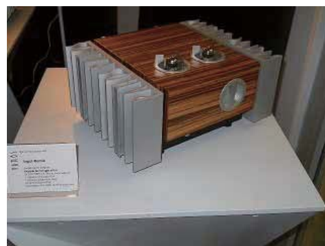
(写真8) 芸術の求める情念を 意味する Pathos を社名に掲げる 同社のインテグレートッドアンプ。 会社のロゴがヒートシンクとなっ ている。
