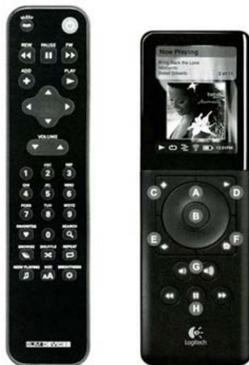
図 2. IR リモコン（向かって左）と Wi-Fi リモコン（同右）
