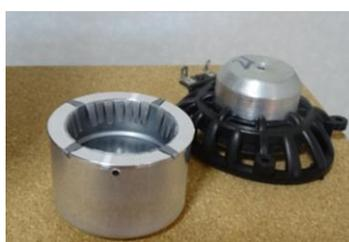
図18 定温カプラー構造図、スピーカユニット
