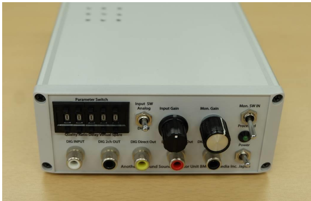
写真3. サンプルの制作に用いた残響分離制御ユニットの外観
