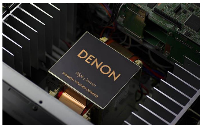
AVR-X7200WA レシーバーのセンターにマウントされたパワートランス
