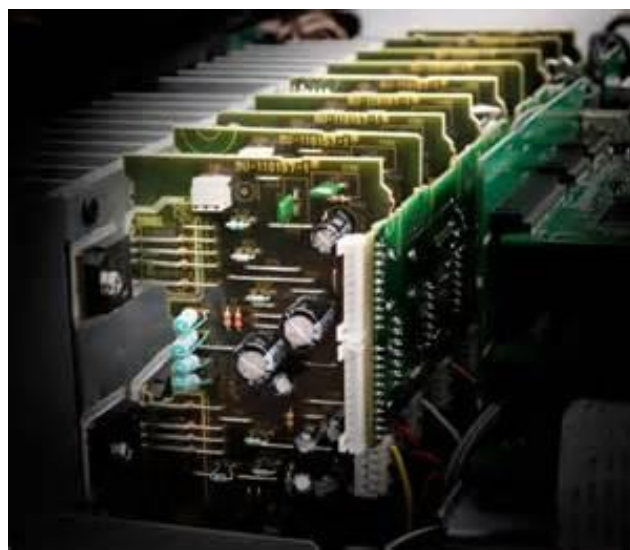
チャンネル毎に基板を独立させたモノリスアンプコンストラクション
