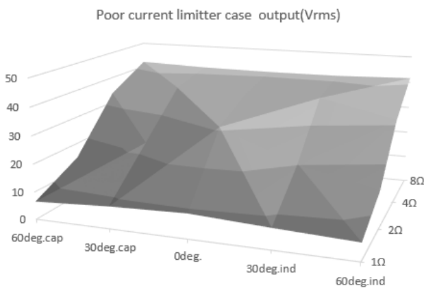
パワーキューブ測定による悪いアンプの評価例 電流リミッターの設定が悪い場合 (スウェーデン Hammabio 誌測定データ 2014年12月号より抜粋)
