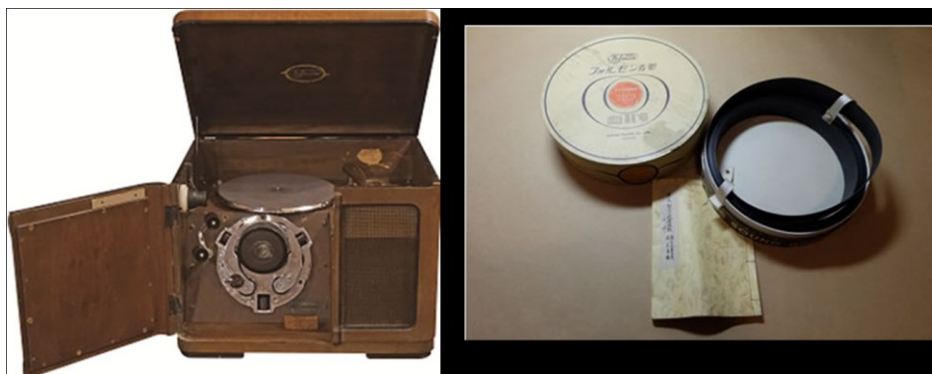
写真6 坪田氏の傑作（1937年）フィルモン再生機（SP盤と兼用）と音帯（記録物） （未来技術遺産登録番号00196号）
