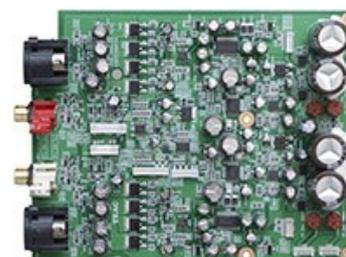
ルがモノラルで完結する回路を2系統持つデュアルモノラル構成は、お互いの信号による干渉を極力防ぎ、特にヘッドホン・リスニングで重要となる左右各チャンネル間の影響を抑えて、高性能ヘッドホンアンプとしてもお使いいただけます。
