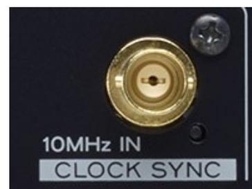
さらに、10MHz 外部マスタークロックの入力にも対応することで、より高精度なマスタークロック信号と同期をさせることが可能。より高精度なクロックと同期させることによって体感できる音質の向上や、音色の変化をお楽しみいただくことが出来ます。
