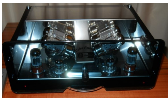
(写真 16) 今回、個人的に面白いと思ったのが ENCORE SEVEN の真空管アンプ、その名も Egg-Shell Prestige。A 級シングルエントッド構成でなんと V8 エンジンのようだ。
