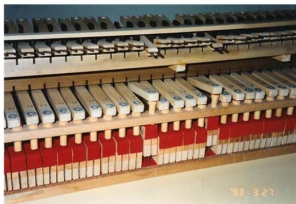
図 4.8 鍵盤のテコを反転する機構
